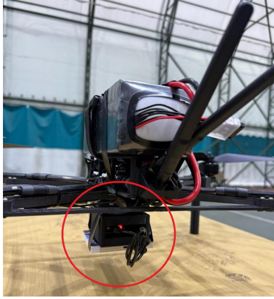
Şekil 37. Sensör Setinin İHA Üzerine Yerleştirilmesi
