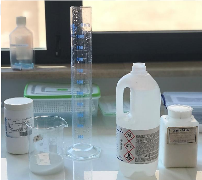
Şekil 15. Boraxla tamponlanmış %5'lik formaldehit çözeltisi hazırlama
