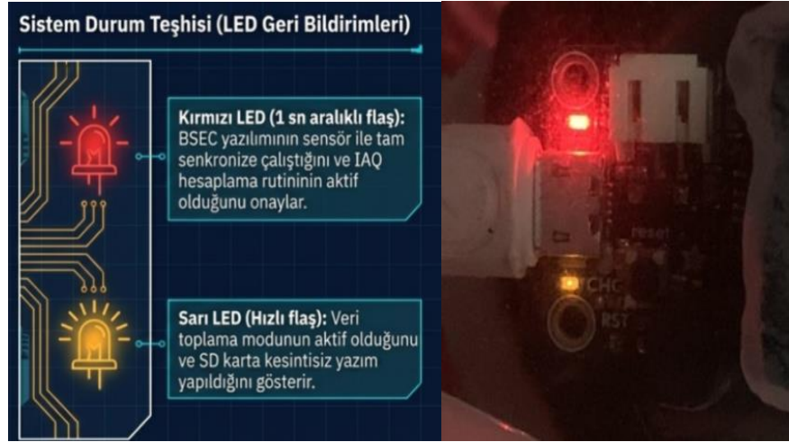
Şekil 14. ESP32 LED Durum Göstergeleri ile Sensör Testi
