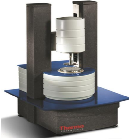
Şekil 29. Viskozite ölçüm reometresi (Haake RheoStress 1, Almanya) İTÜ.
