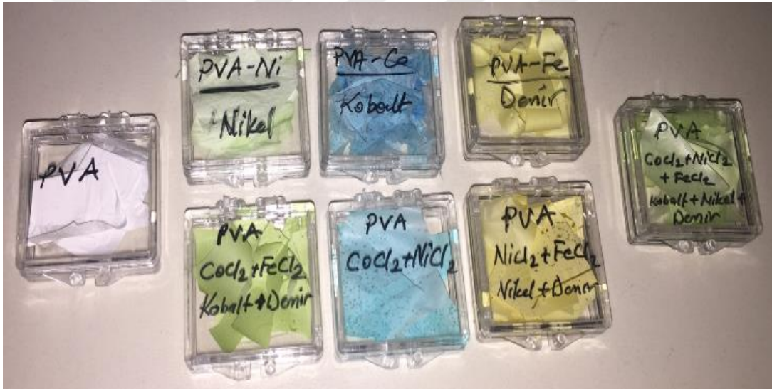
Şekil 35. Farklı manyetik iyonların katkılanması sonucu ( \text{Fe}_3\text{Cl}_2 , \text{NiCl}_2 ve \text{CoCl}_2 ) elde edilen nanofiberler
