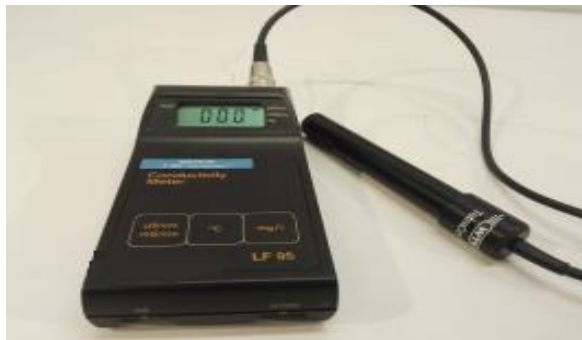
Şekil 30. Elektrik iletkenlik ölçer (WTW LP95 modeli, Almanya) İTÜ.
